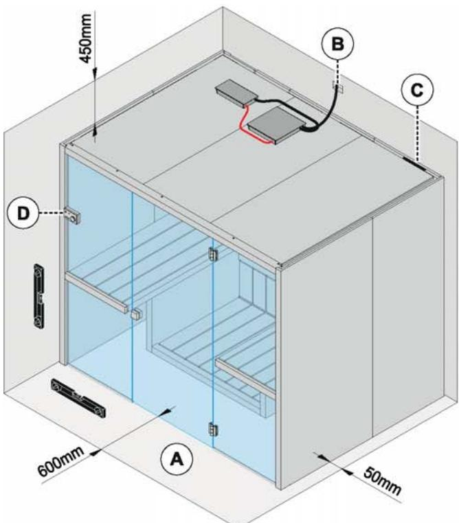
Spazio limitrofo alla sauna per un facile montaggio, al di sotto di tale misura contattare l'azienda.
